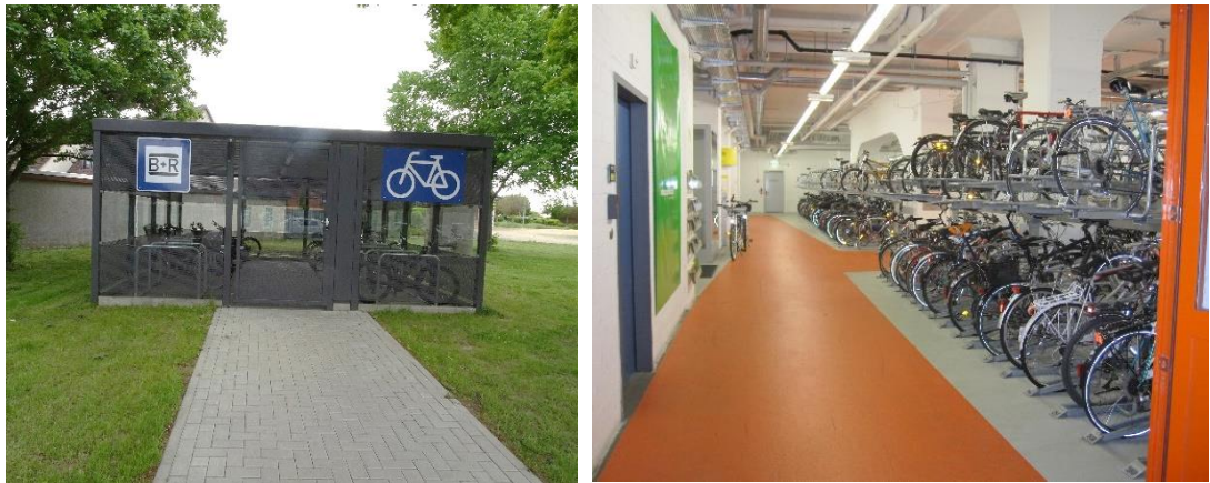
Abb. 6-4: Fahrrad-Sammelschließanlage am Bahnhof Lengede (links) und eine Fahrradstation am Bahnhof Zürich mit Doppelstockparkern (rechts)
